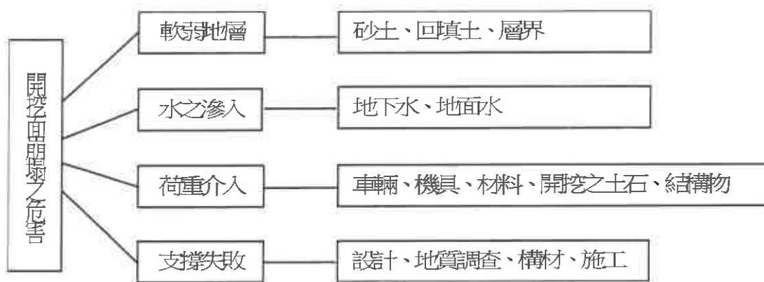
圖3.1 開挖面崩塌之危害狀況引導圖
